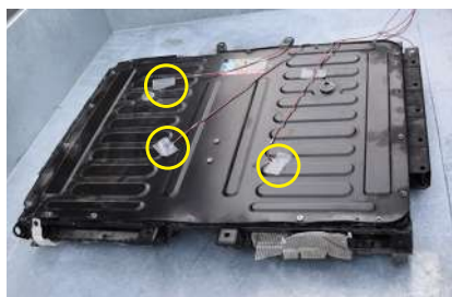
每個盒子有 4 個感測器進行溫度監控
